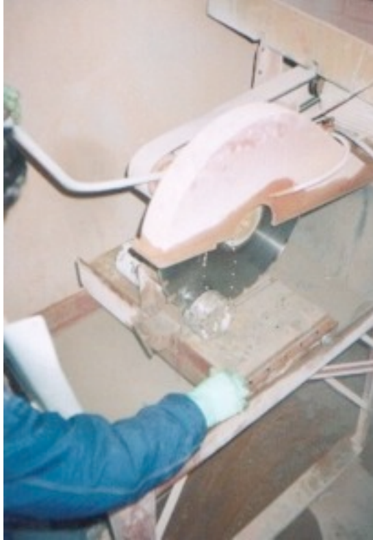
Fotografia 2: Corte dos testemunhos no preparo do ensaio
