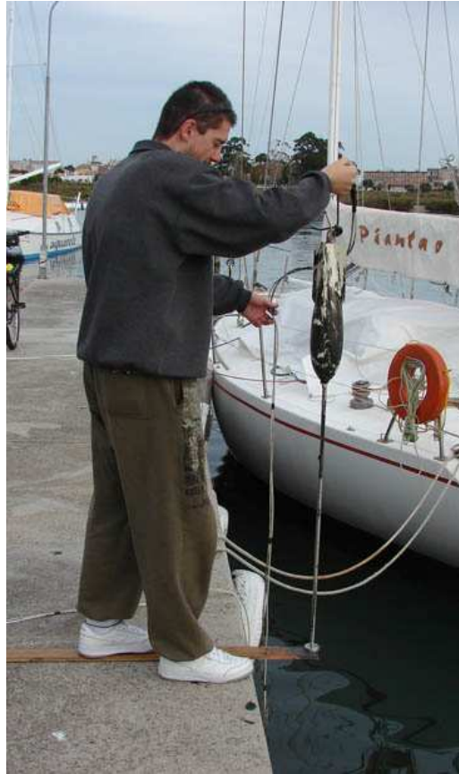
Figura 6. Testes de lançamento com o penetrômetro construído.
