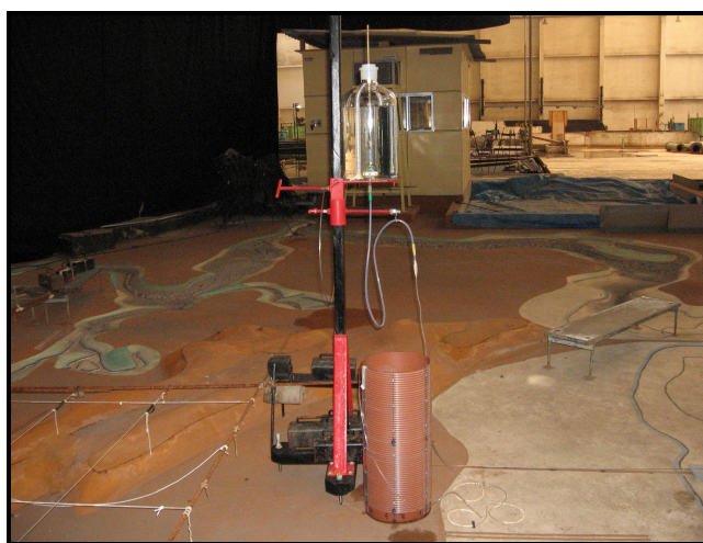
Figura 6 – Sistema de suporte do frasco de Mariotte acoplado ao dissipador
