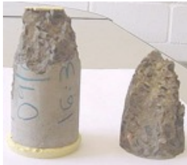
FIGURA 6. Forma de ruptura de corpos-de-prova, preparados por capeamento com enxofre e de topos retificados.
