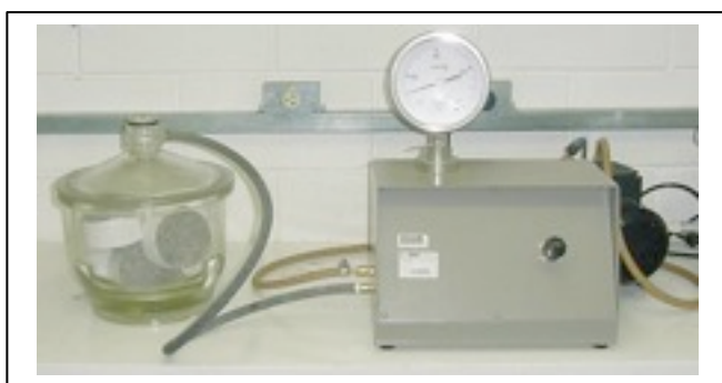
FIGURA 7. Selagem de amostras lateralmente para ensaio de resistência à penetração de cloretos e acondicionamento de amostras em dessecador à vácuo para ensaio de resistência à penetração de cloretos.
