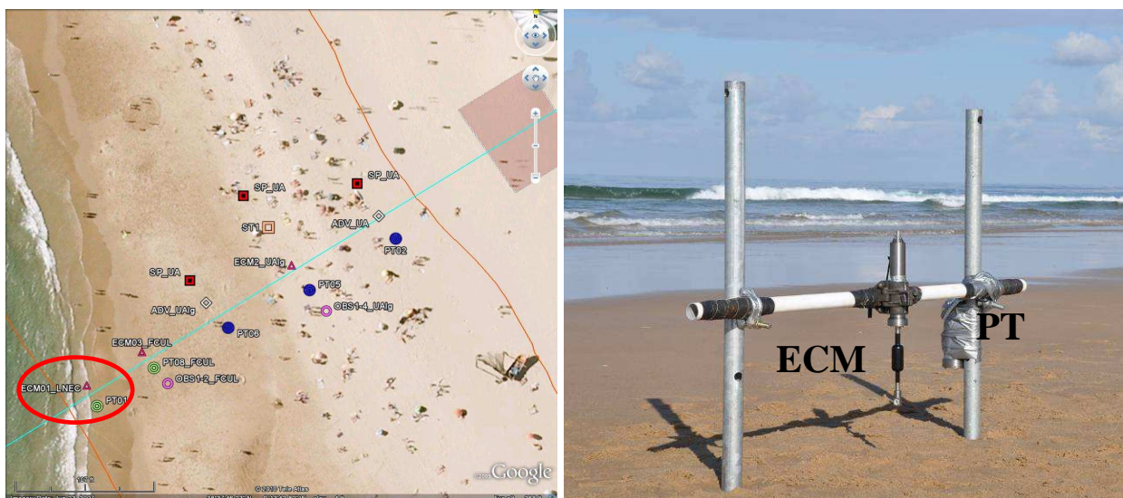
Figura 14: a) Perfil da praia onde foram posicionados os equipamentos. b) Em destaque o Correntômetro (ECM) e sensor de pressão (PT).
