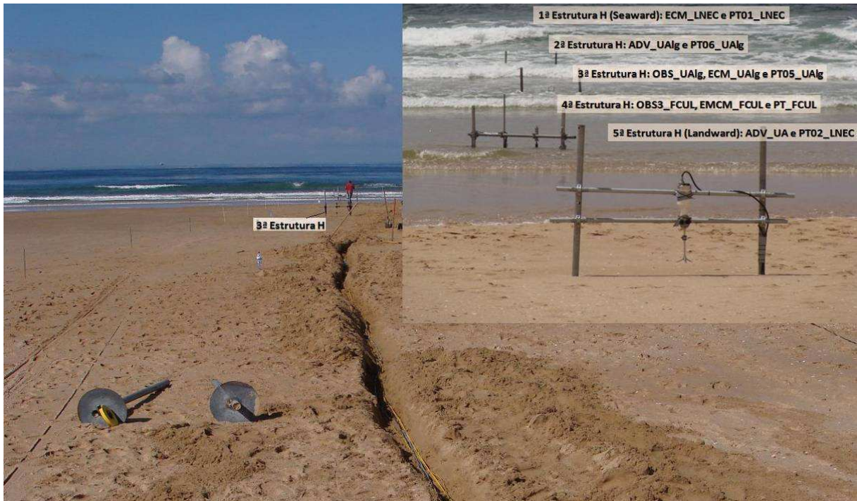
Figura 13: Fotografia com localização do perfil com os equipamentos e esquema com localização das estruturas H usadas na campanha. (montagem da autoria da UAlg).
