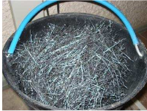
Figura 3 – Fibras de aço utilizadas no ensaio.
