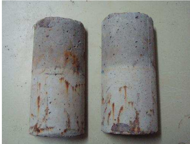
Figura 9 – Análise das manchas em cp sujeito ao ensaio de compressão diametral.
