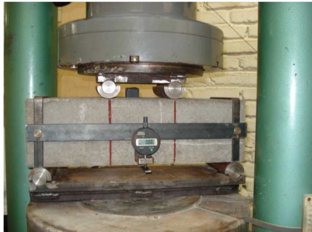
Figura 4: Execução do ensaio de tração na flexão
