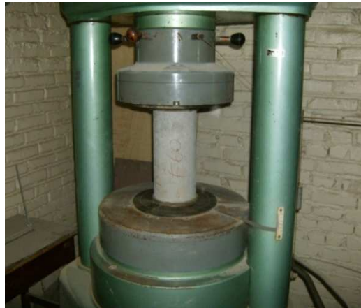
Figura 2 - Execução do ensaio de compressão axial
