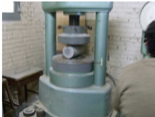
Figura 3 – Execução do ensaio de tração por compressão diametral
