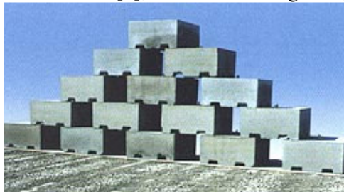
Figura 1 - Blocos construídos pela NKK a partir de escória de aciaria.
