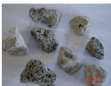
Figura 2 – Foto da escória bruta de alto-forno.
