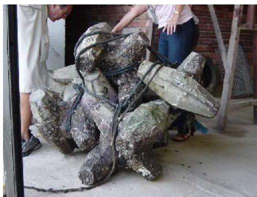
Figura 11 - Blocos retirados do ambiente marinho, após 1 ano.
