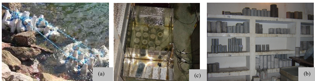
Figura 4 – (a) Blocos em ambiente marinho; (b) corpos-de-prova em tanque simulando o ambiente marinho; (c) Corpos-de-prova na câmara úmida.
