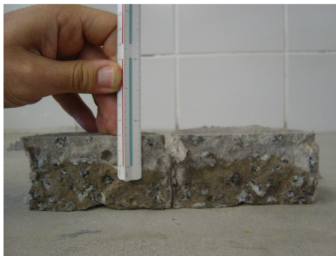
Figura 4 – Determinação da profundidade de penetração de cloretos com o auxílio de solução de nitrato de prata.
