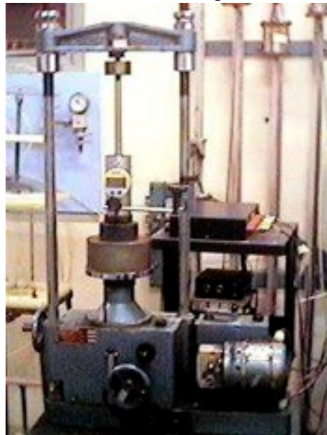
Foto 1. Ensaio mini-CBR em prensa elétrica, com medida por célula de carga e aquisição automática dos dados de carga
