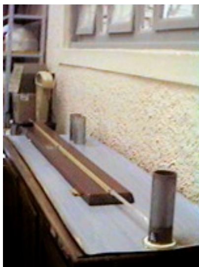
Foto 4. Ensaio de infiltrabilidade pela Metodologia MCT
