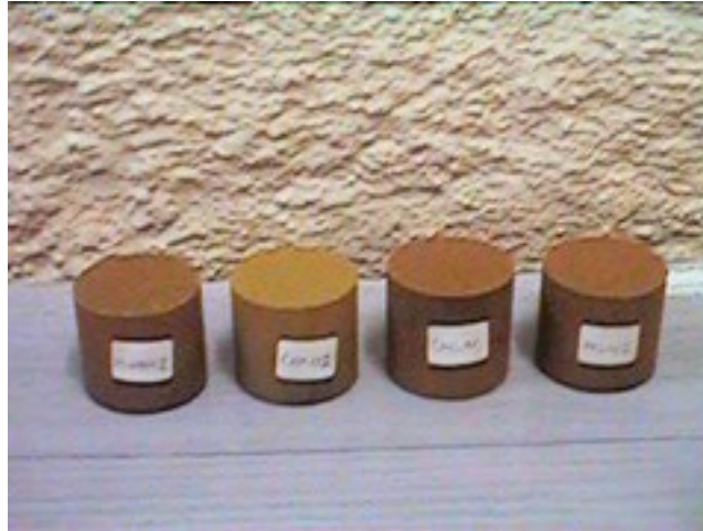
Foto 3. Ensaio de contração por secagem ao ar da Metodologia MCT
