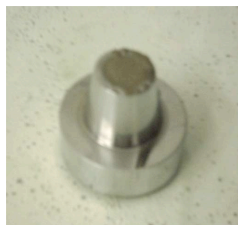
Figura 2b – Minitronco de cone preenchido com a pasta de cimento.
