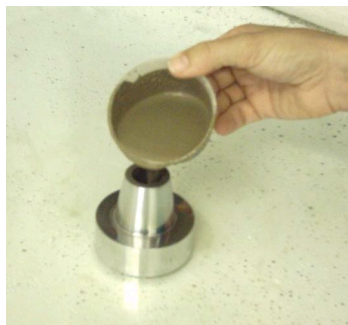
Figura 2a – Preenchimento do minitronco de cone com a pasta de cimento.
