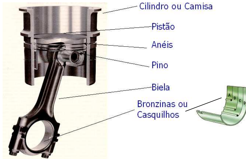
Figura 2 – Principais componentes de motores sujeitos a desgaste evidenciado pela análise do lubrificante
