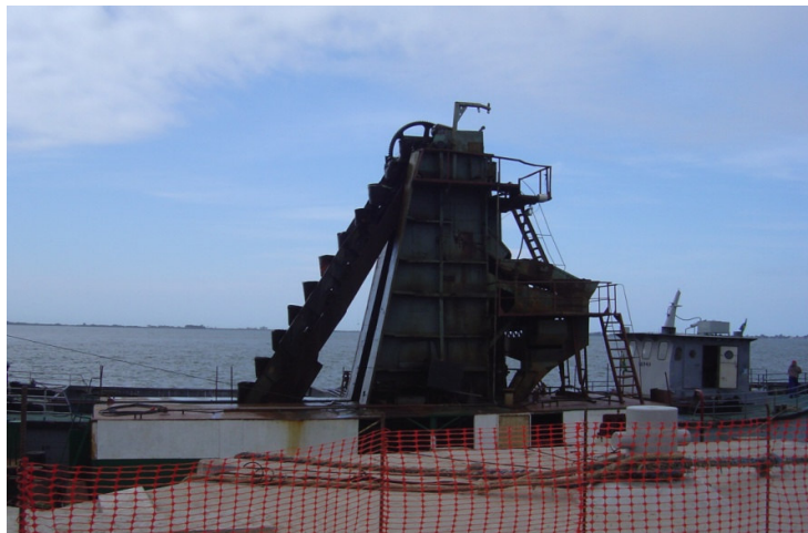
Figura 1 - Draga de Alcatruzes operando no Porto do Rio Grande
