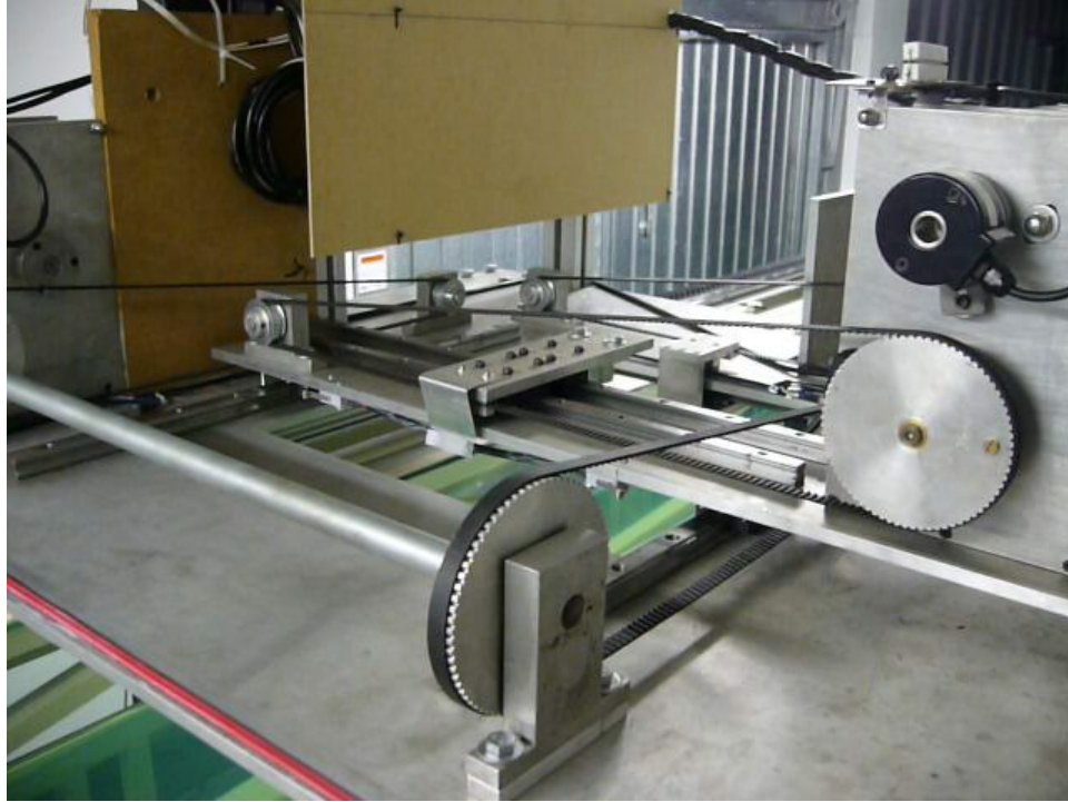
Figura 2. Foto mostrando detalhes do acionamento da plataforma móvel.
